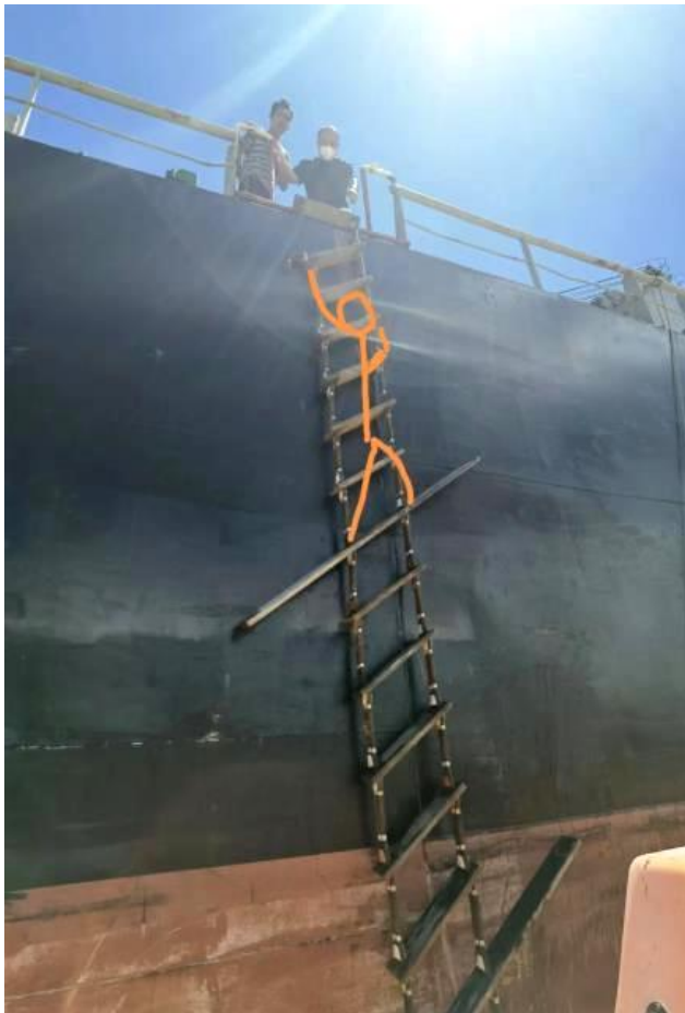
2022年域内PSC検査における不適合事例 （左：パイロットラダーの損傷、右上：換気装置の腐食、右：消火管の破孔）
