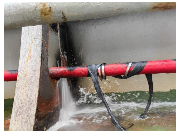
2022年域内PSC検査における不適合事例 （左：パイロットラダーの損傷、右上：換気装置の腐食、右：消火管の破孔）
