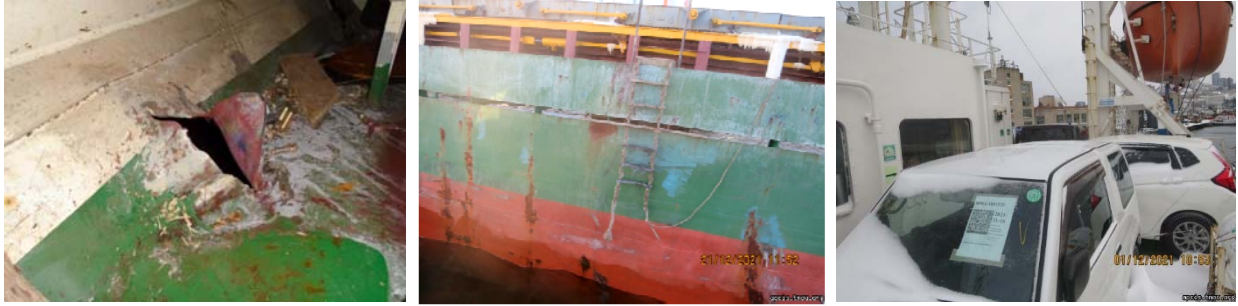
2021年域内PSC検査における不適合事例 (左：船体外板損傷、中央：パイロットラダーの損傷、右：救命艇招集場所の貨物搭載)
