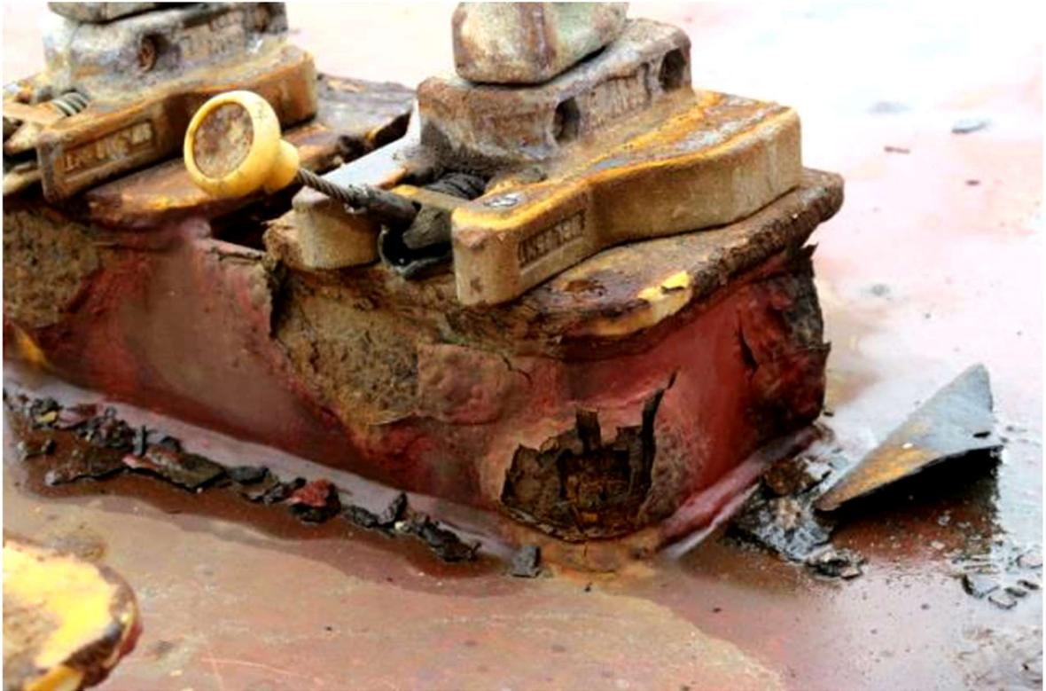
2018 年表彰：2018 年 5 月 27 日 中国・上海港（コンテナ船：固縛装置の過度な損耗）
